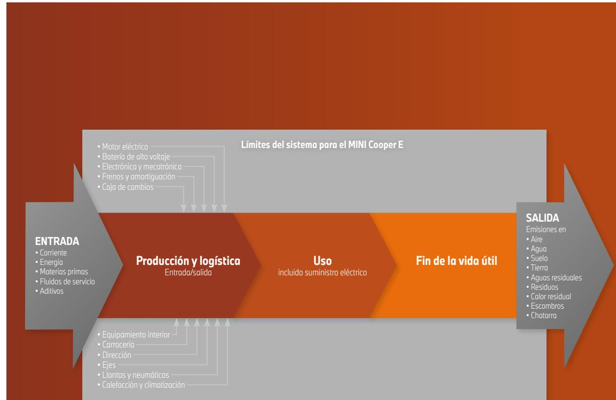
Fig. 1: Límites del sistema para el ACV del MINI Cooper E
